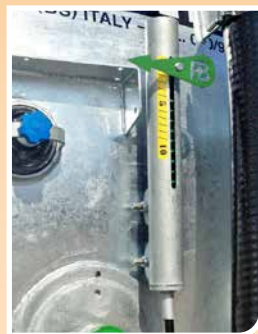
Indicatore di livello e profondità interratore Level gauge with float and depth indicator of the injector
