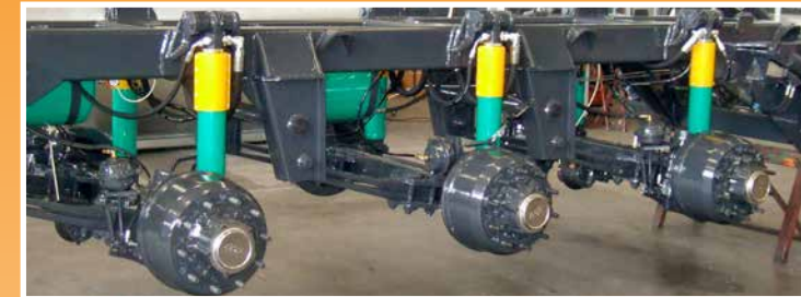
Sospensione oleodinamica con cilindri idraulici doppio effetto Oleodynamic suspension with double-acting hydraulic cylinders
