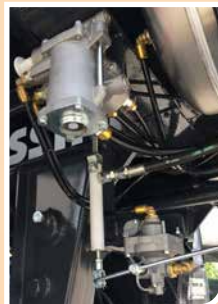
Sistema di sterzata comandata con attacco cilindri indipendente dalla trattrice
