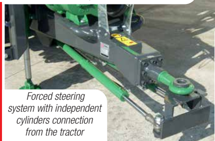
Sistema di sterzata comandata con attacco cilindri indipendente dalla trattrice
