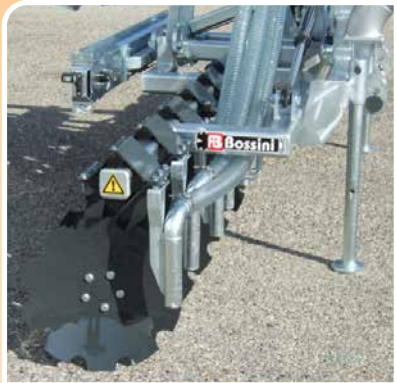
Diffusore di spandimento su saracinesca idraulica laterale con gittata di 10 m Spreader tool on hydraulic lateral valve with 10 m range
