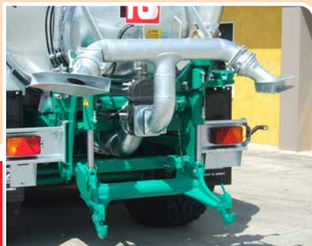
Ventaglio spargitore tradizionale singolo o doppio con larghezza di lavoro da 10 a 15 m Standard single spreader plate or double with working width from 10 to 15 m
