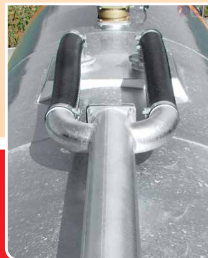
Doppia valvola primaria antischiuma rialzata in posizione centrale al serbatoio + doppia entrata nel serbatoio della tubazione di carico Double anti-foam primary valve in central position on the tank + double inlet into the tank of the charge pipe
