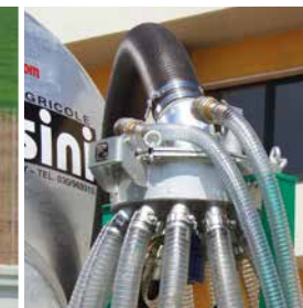
Distributore idraulico con uscite Ø 60 mm per dosare regolarmente il liquido in ogni uscita Hydraulic motorized slurry distributor with exits Ø 60 mm for subdivide the liquid in every exit
