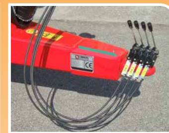
Distributore idraulico a comando manuale Mechanical hydraulic control
