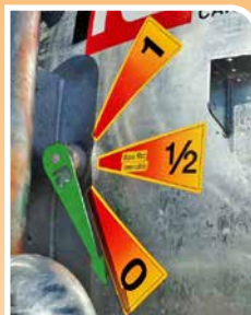
Indicatore di livello e profondità interratore Level gauge with float and depth indicator of the injector
