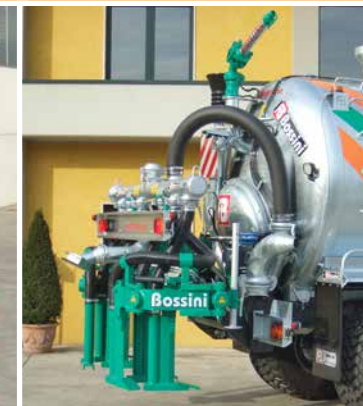
Interratore a 6 ancore snodate per sollevatore idraulico e con possibilità di utilizzo del ventaglio spargitore posteriore
