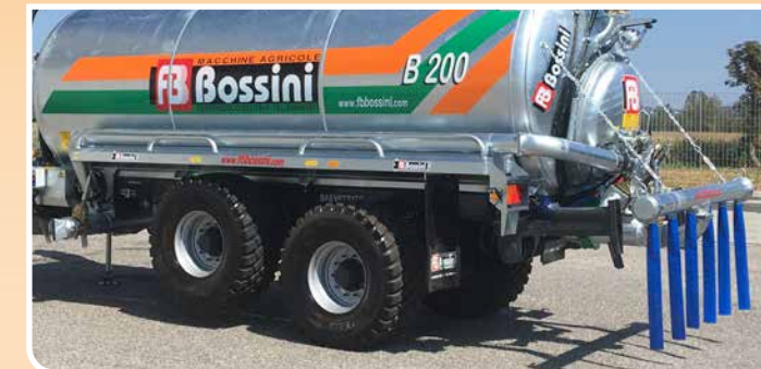
Sistema di scarico totale in discesa con doppia saracinesca idraulica da 8" invertita e tubazione di collegamento Total unload system in downhill with double hydraulic valve 8" inverted and connecting pipe
