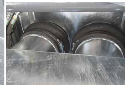
Doppia valvola primaria antischiuma rialzata in posizione centrale al serbatoio + doppia entrata nel serbatoio della tubazione di carico Double anti-foam primary valve in central position on the tank + double inlet into the tank of the charge pipe
