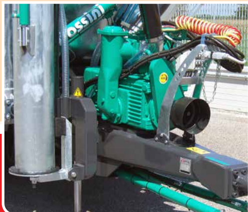
Decompressori per vuoto: con palette o rotori in acciaio Vacuum pump: with blades or with lobe rotors
