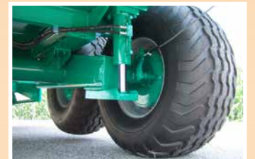
Sollevamento del 1° asse per l'incremento del carico sul gancio di traino, per veicoli a 2 assi Lifting 1st axle to increase the load on the eyelet, for vehicles with 2 axles
