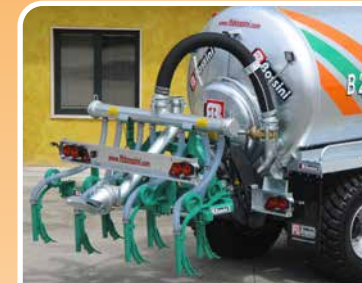
Interratore a 7 ancore a molle, per sollevatore idraulico - interasse lavoro di 0,42 m - larghezza lavoro di 2,55 m - tubi flessibili Ø 80 mm
