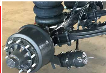
Bi-elemento frenante per servizio + parcheggio Double brake chamber for braking + parking
