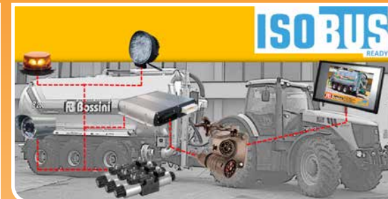
Sistema di gestione Isobus di tutte le funzioni del Carro Botte Isobus system for the function control of the Slurry Spreader
