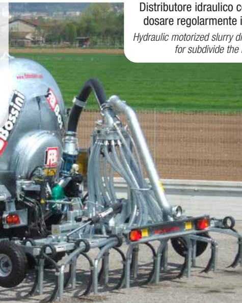
Interratore a 13 ancore per sollevatore idraulico con: - interasse lavoro di 0,44 m - larghezza lavoro di 5,3 m - tubi flessibili Ø 60 mm - molle a sezione quadra 35x35 mm - dente temprato reversibile da 55 mm - n°2 ruote regolabili 10.0/80-12 - richiudibile idraulicamente
