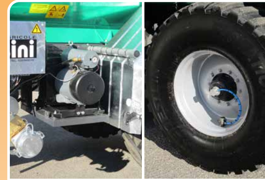
Sistema di sgonfiaggio/gonfiaggio pneumatici mediante compressore aria motorizzato idraulico. Tyre deflation/inflation system by means of a hydraulic motorized air compressor.
