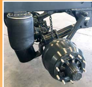
Sospensione pneumatica con diapress e semibalestra tipo Z Air suspension with diapress and spring type Z
