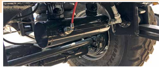
Sistema di sterzata comandata elettro-idraulica con trasduttore angolare al gancio di traino e sensore sulla cerniera dell'assale Electro-hydraulic steering with angle sensor on the eyelet and angle sensor on the axle hinge
