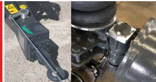
Sistema di sterzata comandata elettro-idraulica con trasduttore angolare al gancio di traino e sensore sulla cerniera dell'assale Electro-hydraulic steering with angle sensor on the eyelet and angle sensor on the axle hinge
