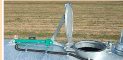
Apertura superiore idraulica con guarnizioni Hydraulic upper opening with gasket
