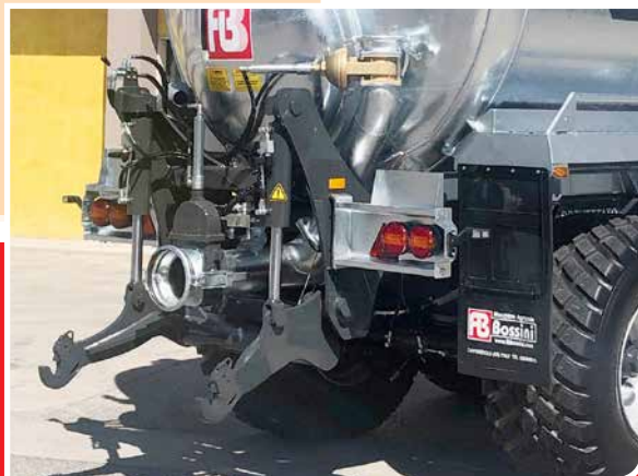
Sollevatore posteriore idraulico che permette l'aggancio di varie attrezzature Rear hydraulic linkage for the connection of different equipment
