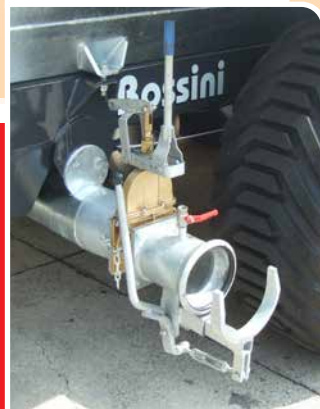
Saracinesca manuale con sistema di aggancio rapido Manual valve with quick coupling system
