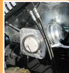
Misuratore della concentrazione dei nutrienti nei liquami (azoto totale, azoto ammoniacale, fosforo e potassio) Slurry nutrient concentration measurement (total nitrogen, ammonia nitrogen, phosphorus and potassium)
