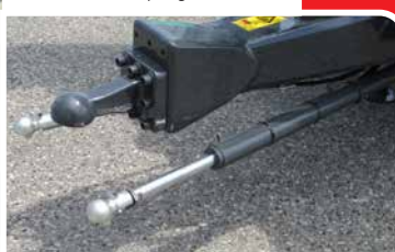
Cilindri di comando con attacchi a calotta K50 Forced steering cylinders with coupling K50
