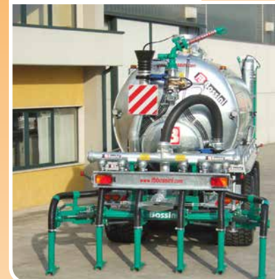
Interratore a 6 ancore snodate per sollevatore idraulico e con possibilità di utilizzo del ventaglio spargitore posteriore
