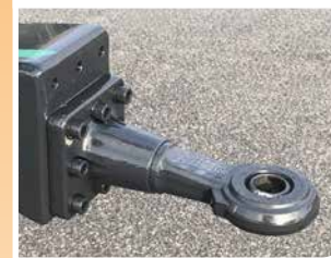
Gancio F3 con 2 posizioni Hitching eyelet type F3 with 2 position
