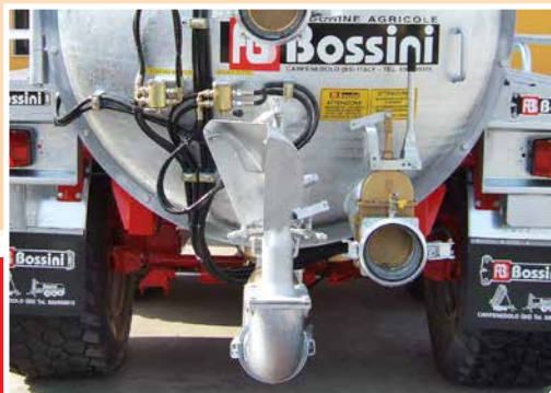
Ventaglio spargitore con movimento rotatorio, larghezza di lavoro da 10 a 18 m Spreader plate with turning movement, working width from 10 to 18 m
