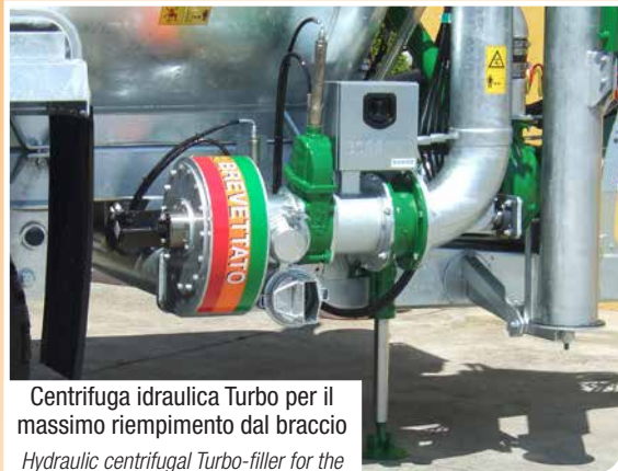
Centrifuga idraulica Turbo per il massimo riempimento dalla saracinesca laterale Hydraulic centrifugal Turbo-filler for the maximum load from the lateral valve
