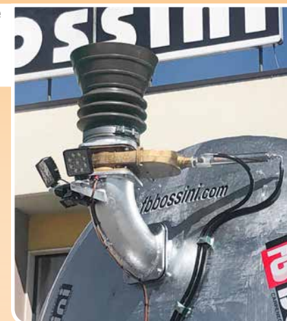
Cono in gomma per aspirazione da semovente Rubber cone for suction from self-propelled
